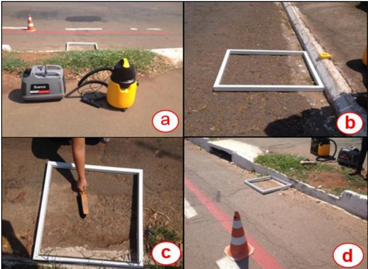
Figura 25- Equipamentos utilizados na execução das coletas dos sedimentos.
